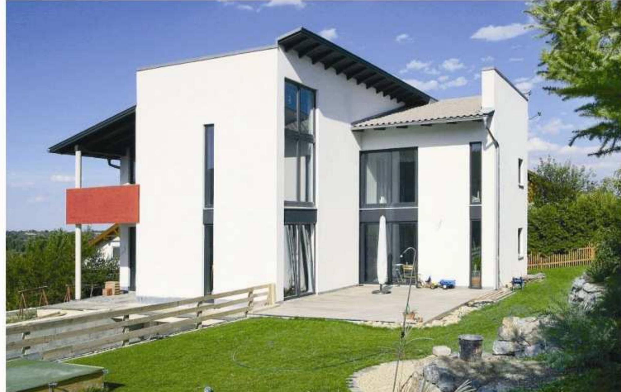
15 kWh / m<sup>2</sup> pasif ev standardı; mevcut hava verme sistemine gerekli olan ısıtma sıcaklığını naklettiğinden, ayrıca bir ısıtma sisteminin gerekliliğini ortadan kaldırın ekonomik bir düşünce esasına dayalıdır.
