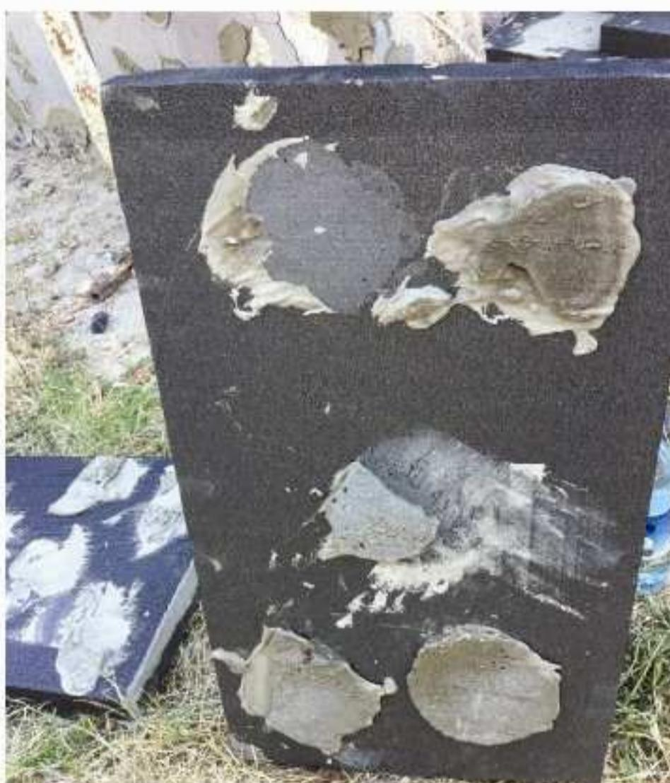
Şekil 3 - Yüzey iyileştirmesi yapılmayan yüzey yanlış uygulama
